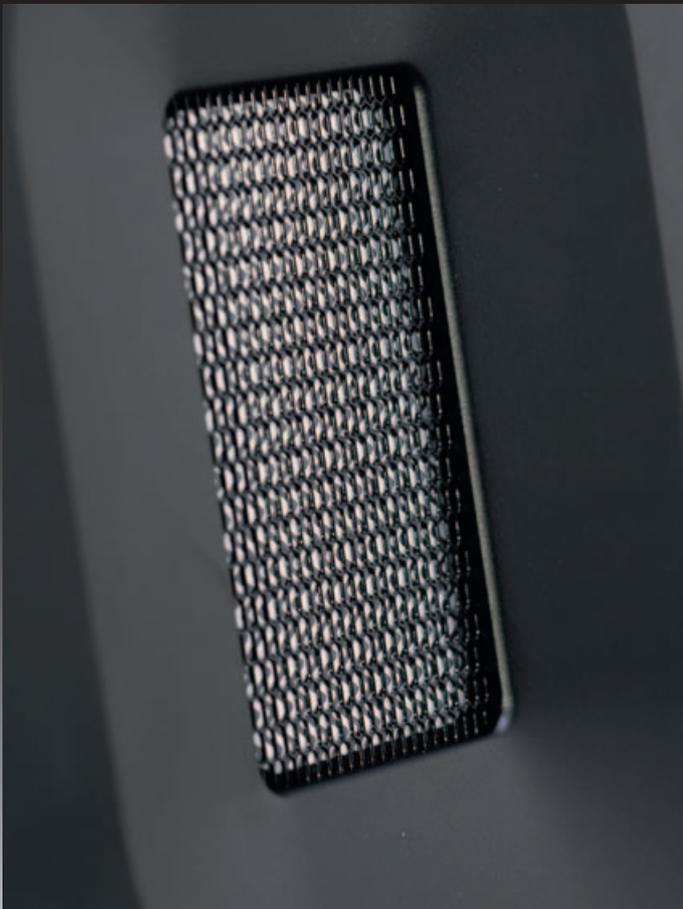
Das von Raidho selbst gefertigte Bändchen ist mit 20 Milligramm Membrangewicht rekordverdächtig. Das antreibende Array Neodym-Magneten ist so stark, dass es ausschließlich hinter der Folie arbeiten kann, die Schallabstrahlung wird also nicht behindert.
