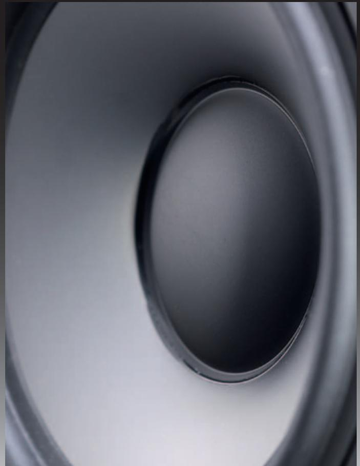
Die 13-cm-Konen spielen mit einer Membran aus einem Keramikträger, der erst graphit- und dann diamantbeschichtet wird. Bis zu 1,5 Karat (!) an feinsten Diamantpartikeln werden pro Konus aufgebracht und gehen mit dem Graphit eine harte sowie bedämpfte Verbindung ein.
